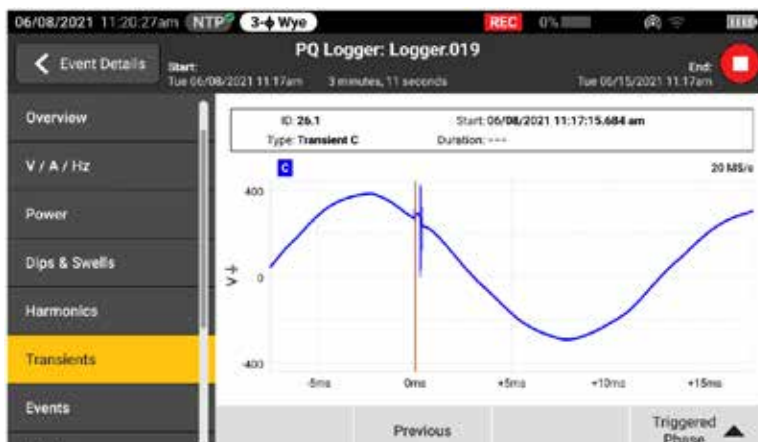
Affichage en temps réel des événements transitoires de tension pendant l'enregistrement pour un dépannage plus rapide
