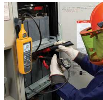
Mesurez l'impédance avec le testeur de batterie Fluke BT521.
