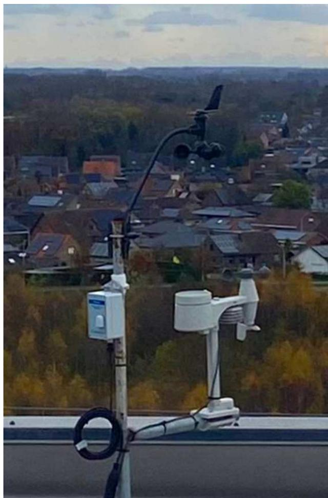
Photo : Présentation de la solution de mesure où les vitesses/directions des vents, la quantité et la température des précipitations et la teneur en particules sont mesurées et surveillées.
